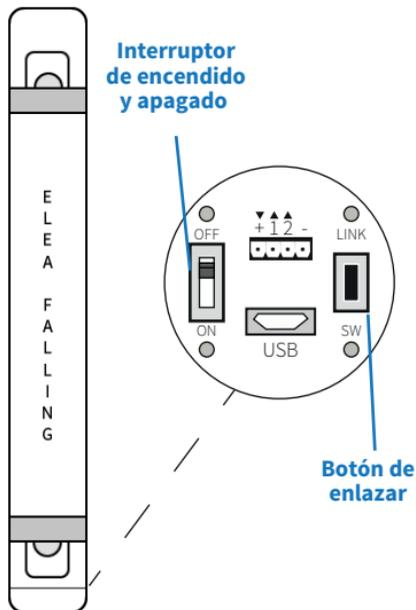
A continuación, desenroscar la parte inferior del detector de caidas y cambiar la posición de off a on.
